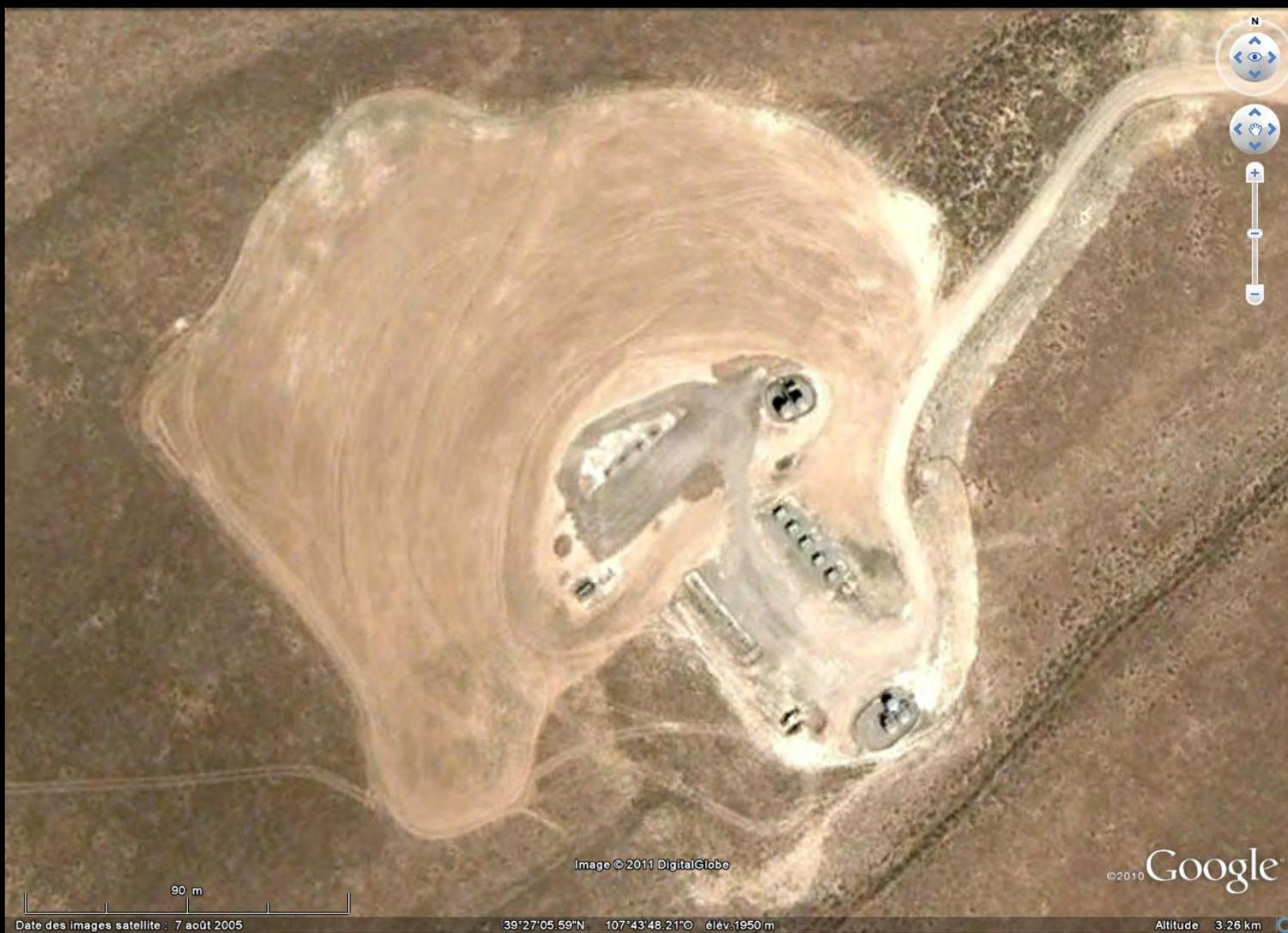
**Voici ce que donne un puits en cours de forage vu de près dans le Colorado en 2005. Une fois le forage fini, l'emprise au sol est divisée par 4 x 4**
